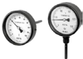
A medição da temperatura é feita através do sistema bimetal que consiste em duas tiras de metais coladas.
